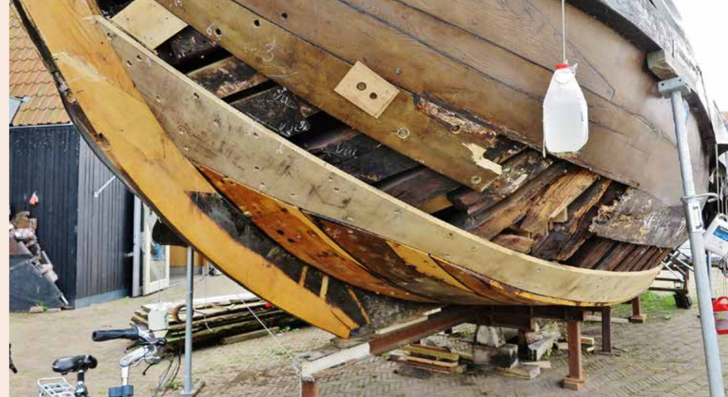
Hier is goed te zien dat de kiel van de botter vernieuwd moet worden
